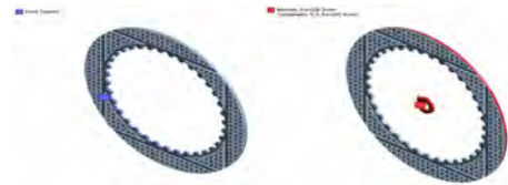
Fig. 2 Friction Plate 구조해석 경계조건
